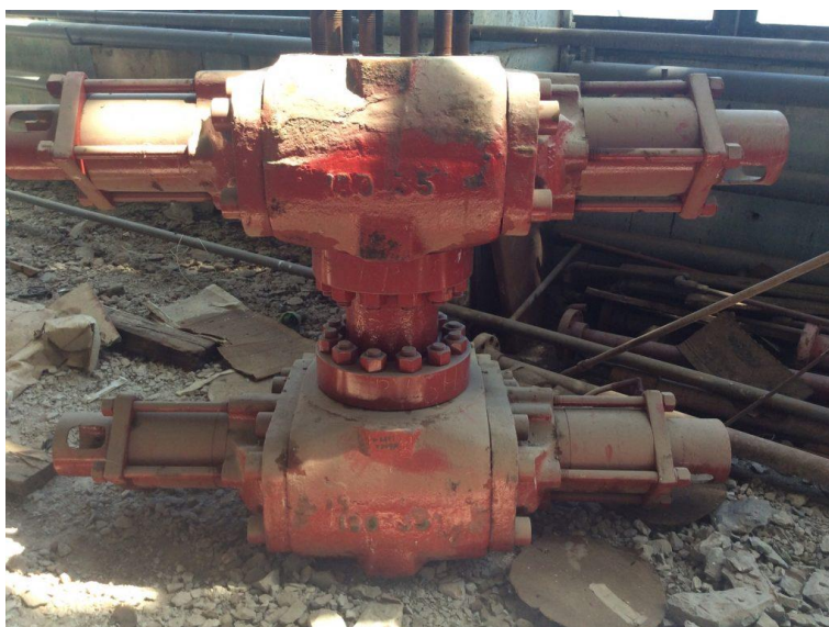
3.1 – сурет. Істен шыққан плашкалы превентордың көрінісі
